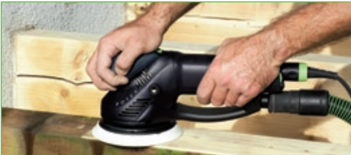
Przy szlifowaniu zgrubnym zwietrzałych belek.
